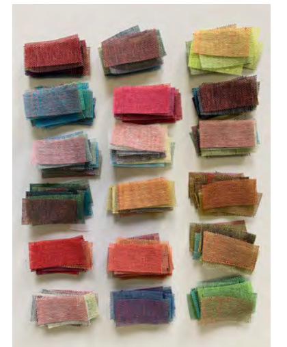
In linnenbinding ontstaat kleurmenging door mix van schering en inslag. Met een voorraad van 18 kleuren linnen zijn 171 kleuren mogelijk. Door de geweven swatches naast elkaar te houden kunnen kleurcombinaties onderzocht worden.
